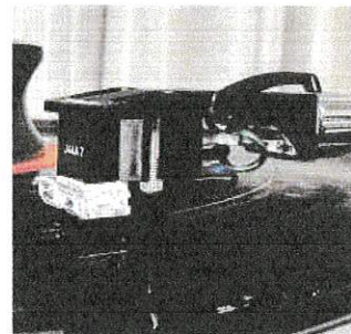
使用カートリッジJICO「J44A 7 IMP NUDE」+テクニクス製ヘッドシェル。交換針は「N44-7」(無垢丸針、針圧1.5~3.0g)
